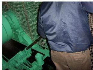
Figura 17, Mecanismo de freno de emergencia en maquina funicular.
